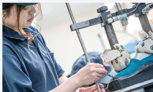
平面の素材から立体的の履物へと仕上げる「吊り込み」作業。機械化は難しく、どうしても人の手が必要な部分です。しわは靴底に隠し、表から見えない様に気を配ります。特につま先が二股に分かれた足袋の形に仕上げるためには、熟練の技、丁寧な手仕事求められます。現在日本では手作業で製造しているところは少ないのですが、丸五では本社工場でもこの作業を行い、日本でこの技能を途絶えさせぬよう、若い世代への技能継承に力を注いでいます。
