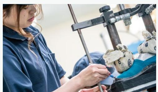
平面の素材から立体の履物へと仕上げる「吊り込み」作業。機械化は難しく、どうしても人の手が必要な部分です。しわは靴底に隠し、表から見えない様に気を配ります。特につま先が二股に分かれた足袋の形に仕上げるためには、熟練の技、丁寧な手事が求められます。現在日本では手作業で製造しているところは少ないのでですが、丸五では本社工場でもこの作業を行い、日本でこの技能を途絶えさせぬよう、若い世代への技能継承に力を注いでいます。
